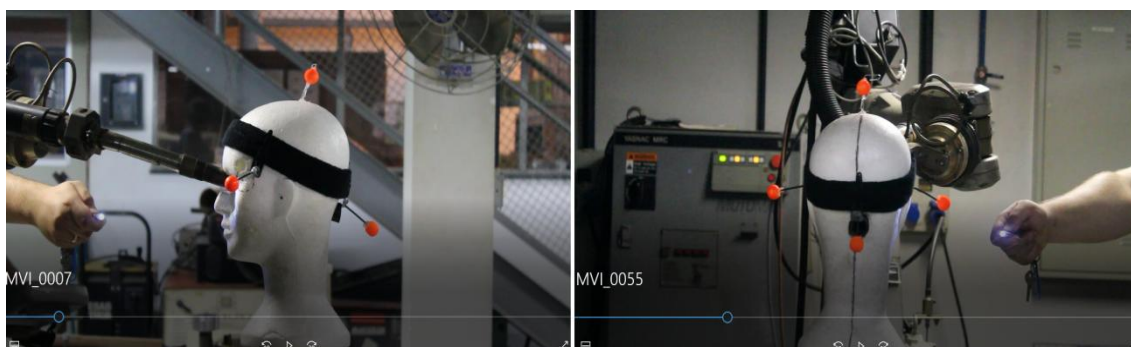
Figura 3-20: Validação do Sistema de Estereofotogrametria contra um valor verdadeiro. À esquerda, imagem registrada pela CAM 1. À direita, imagem registrada pela CAM 2. A luz da lanterna acesa pelo pesquisador indica o quadro inicial de cada vídeo para a sincronização das imagens.
