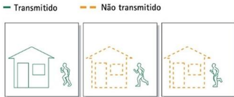
Figura 3-5: Previsão para codificar quadros e Estimação de Movimento.
